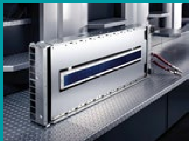
Trotz vieler Vorteile noch nicht für alle Härtungsaufgaben geeignet: LED-UV-Strahler an einer Bogenoffsetdruckmaschine.
